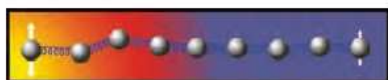
در نافلزات گرما صرفاً از طریق ارتعاش اتم‌ها انتقال می‌یابد. در شکل، این انتقال ارتعاشات توسط فنرها شبیه‌سازی شده است.
